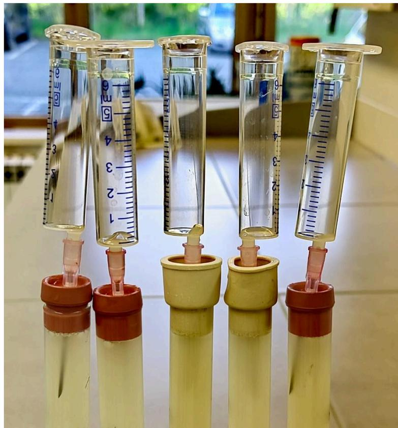
**Abbildung 1.1.** Versuchsaufbau: Einführen einer medizinischen Nadel in ein Glasröhrchen durch Durchstechen des Gummistopfens und anschließendes Aufsetzen der Spritze.
