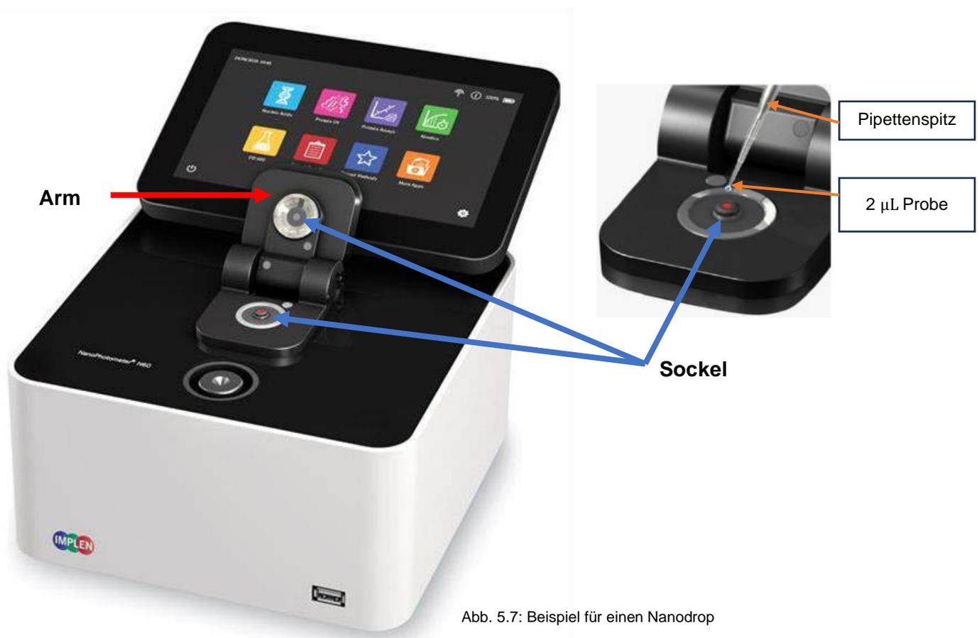
4. Das Nanodrop ist ein UV-Spektrophotometer, mit dem die Konzentration und Reinheit von Nukleinsäuren wie DNA und RNA in kleinen Proben (2  $\mu\text{L}$ ) durch Messung der Absorption bei 260 nm bestimmt werden kann, da dies der Absorptionspeak für Nukleinsäuren ist.
