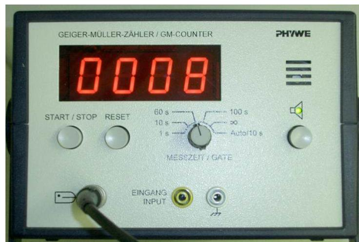
Modell B hat eine Taste mit der Aufschrift "START/STOP" und eine Taste mit der Aufschrift "RESET". Die Messzeit ist auf 60 Sekunden voreingestellt. Bevor ihr eine Messung startet, drückt die "RESET"-Taste, um den angezeigten Wert der letzten Aktivitätsmessung zu löschen. Ihr könnt dann eine Messung starten, indem ihr die Taste "START/STOP" drückt. Die Messung wird nach 60 Sekunden automatisch gestoppt.
